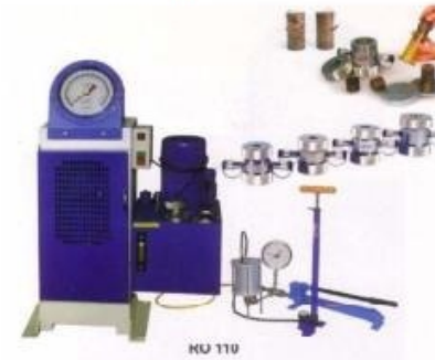
دستگاه بار نقطه‌ای با نمایشگر دیجیتالی ASTM D5731, ISRM
