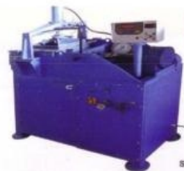
دستگاه برش مستقیم با باکس ۳۰۰×۳۰۰ میلیمتر Large soil direct shear test apparatus
